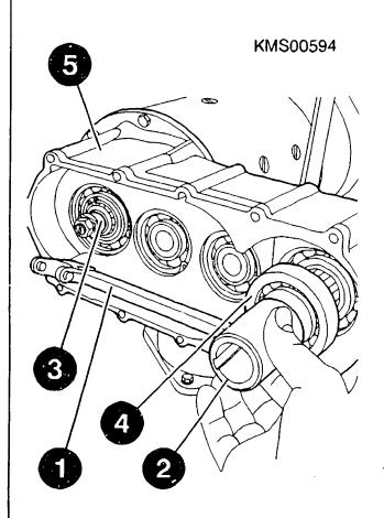
DISASSEMBLING 4-SPEED REUCTION GEAR (TYPE TF 0 001 6....)
